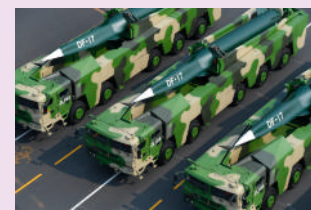
極超音速滑空兵器を搭載可能とされるDF-17準中距離弾道ミサイル 【Avalon/時事通信フォト】
