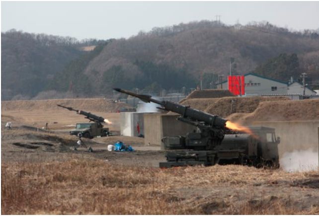
仕様の共通化が図られている陸自11式短距離地对空誘導弾(写真手前)と 空自基地防空用地対空誘導弾(写真奥)
