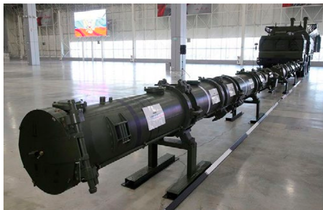
ロシアが初公開した地上発射型巡航ミサイル9M729 (2019年1月)。手前がミサイルのキャニスター、奥が発射台付き車両 【Jane's by IHS Markit】
