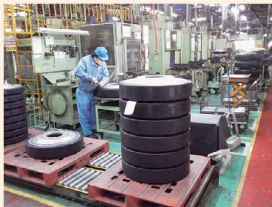
ゴム接着後の転輪のバリ取り作業と完成した転輪
