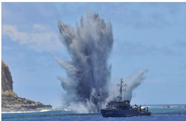
回収した機雷および爆発性危険物を硫黄島で処理する海自掃海艇
