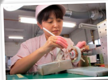
防衛装備関連会社の車長用潜望鏡、砲手用潜望鏡の部品となるレゾルバ(角度センサー)の巻線作業の様子
