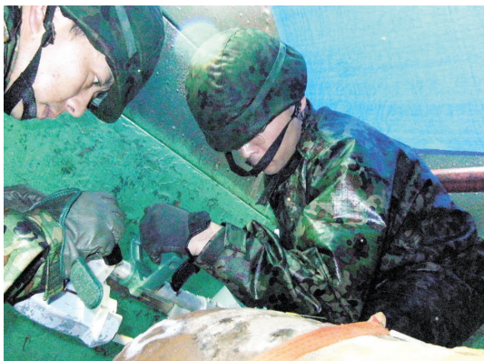
宮崎空港で発見された250kg爆弾を処理する陸自隊員。弾頭の信管を取り除くため、弾殻切断作業を行った。
