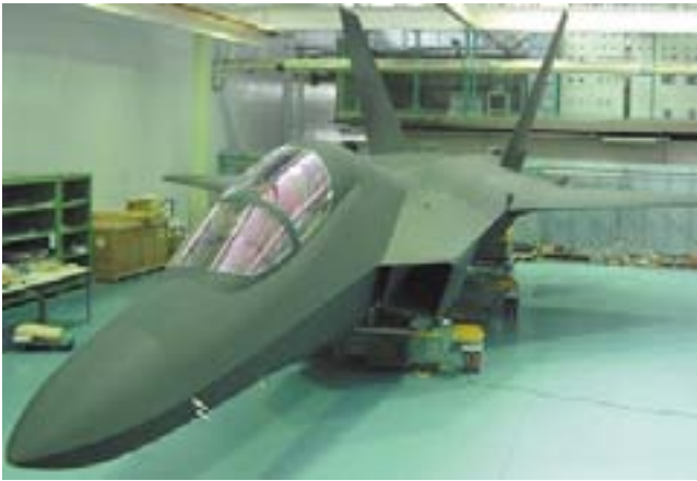
技術研究本部で研究中の ステルス高運動形状の航空機実大模型
