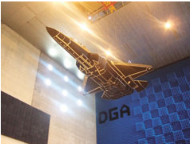
フランスでレーダ反射面積計測中の実大模型
