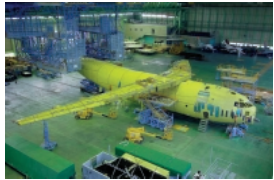
組み立て中の空自次期輸送機静強度試験機
