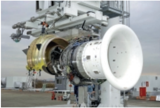
静粛化を図って開発中の海自次期哨戒機用エンジン
