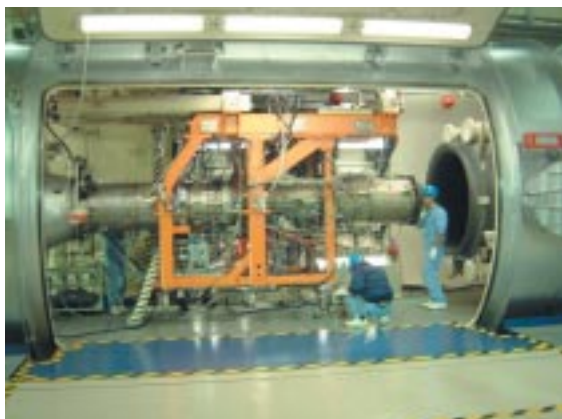
札幌試験場におけるエンジン高空性能試験装置によるエンジンの試験状況（昨年12月 北海道東千歳市）
