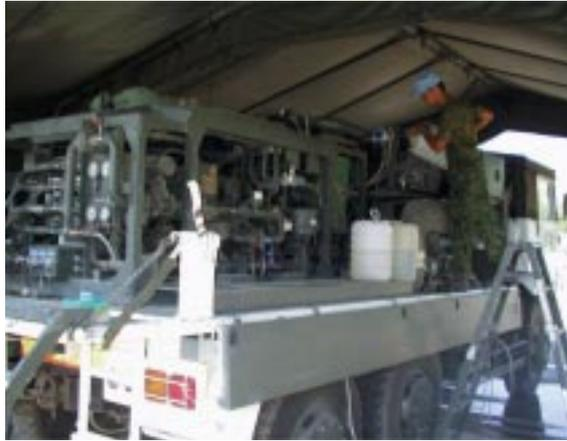
逆浸透膜を使用し水の浄化能力が向上した浄水セット
